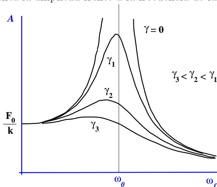
La frecuencia correspondiente al máximo de la amplitud se aproxima a la frecuencia natural del oscilador  $\omega_0$  a medida que el rozamiento disminuye. Además el valor máximo de la amplitud aumenta hasta llegar a infinito cuando el rozamiento es cero. El valor máximo de la amplitud ocurre cuando  $\omega_f^2 = \omega_0^2 - 2\gamma^2$ . Cuando  $\omega_f = \omega_0$  se dice que hay *resonancia*.
