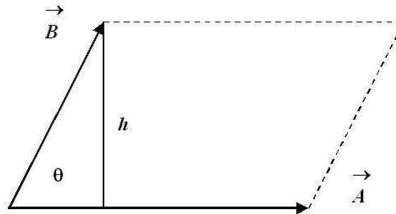
$$|\vec{A} \times \vec{B}| = |\vec{A}||\vec{B}| \sin \theta = |\vec{A}|h = \text{Área del paralelogramo}$$
