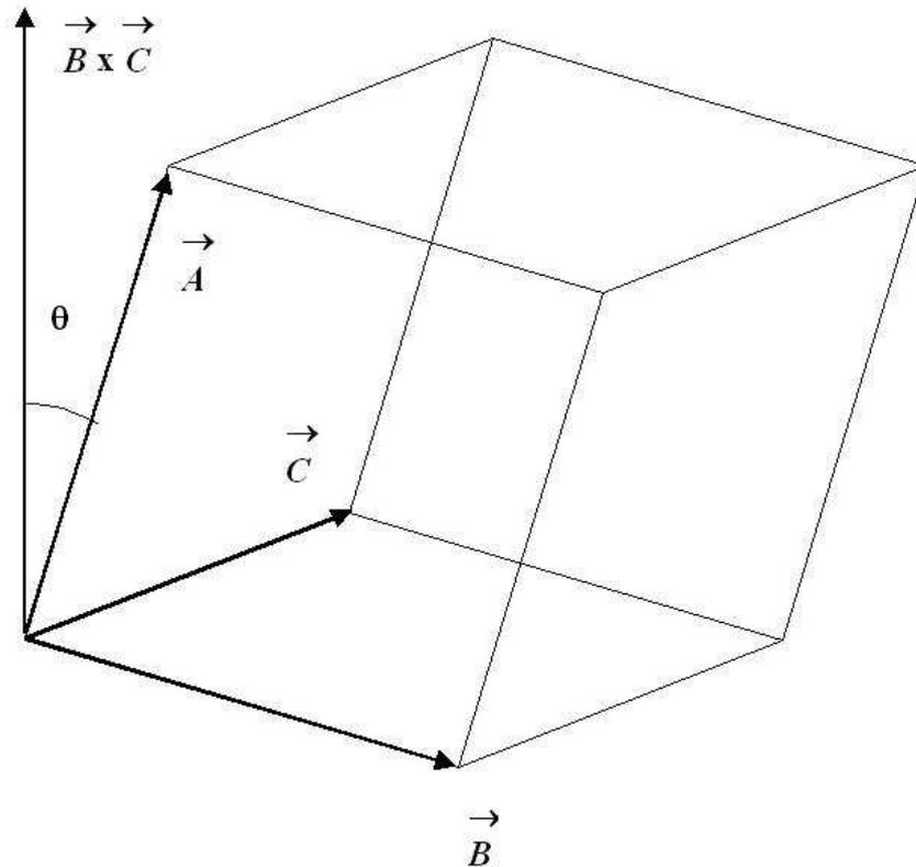
$$\vec{A} \cdot (\vec{B} \times \vec{C}) = |\vec{A}| |\vec{B} \times \vec{C}| \cos \theta = \text{Volumen del paralelepípedo}$$
