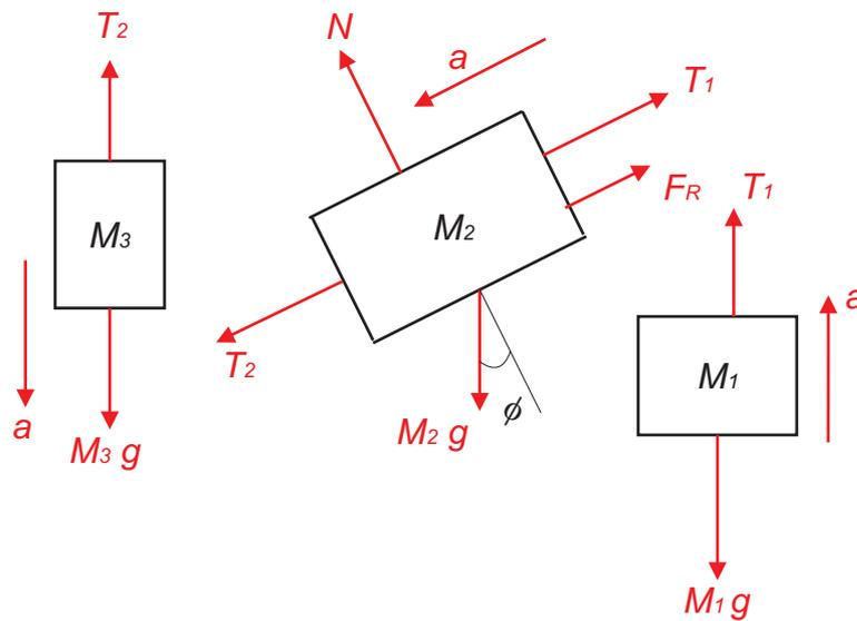
Las fuerzas y la aceleración en las masas  $M_1$  y  $M_3$  llevan todas la dirección vertical, por tanto la ecuación de Newton solo tiene una componente. Para la masa  $M_2$  tomaremos el eje  $X$  paralelo al plano inclinado y sentido positivo hacia abajo y el eje  $Y$  perpendicular al plano inclinado y sentido positivo hacia arriba. Las ecuaciones de Newton son:
